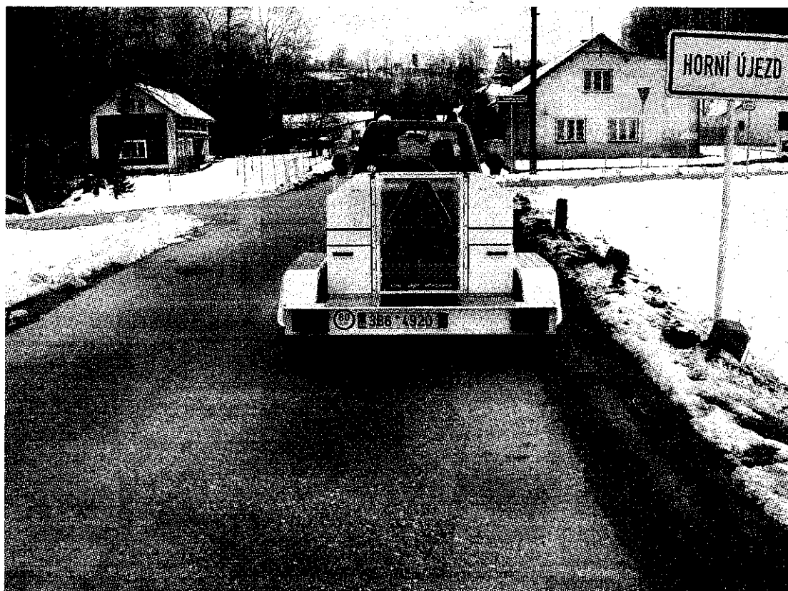
Obr.2 – km 0,400 ; rázové zařízení FWD PRI2100
